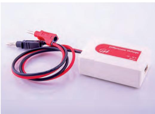
Der Spannungssensor kann für eine Vielzahl an Versuchen zu den Grundlagen der Elektrizität bei einem nutzbaren Messbereich von  $\pm 10$  V sowohl in Gleichstrom- als auch Wechselstromkreisen verwendet werden.
