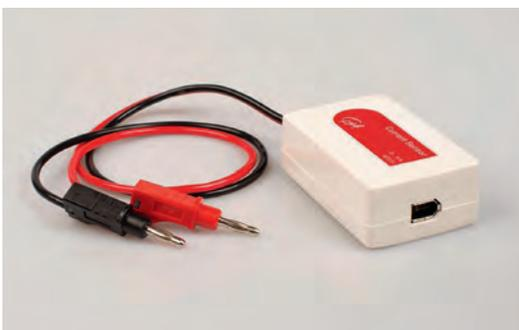
Der Stromsensor ist ein Allzweck-Messinstrument zur Messung der Stromstärke in Gleich- und Wechselstromkreisen. Er kann für die Strommessung im Bereich zwischen -5 und +5 A verwendet werden.
