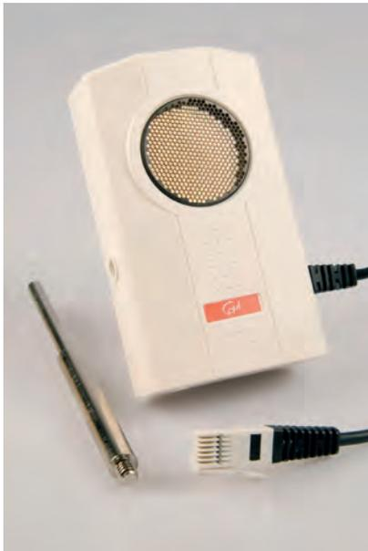
Der Ultraschall Bewegungsdetektor ist in der Lage, die Position eines Körpers im Raum über Ultraschallwellen und abhängig von der Größe, Form, Ausrichtung und Oberflächenbeschaffenheit in Distanzen zwischen 0,2 und 6 bis 12 m zu messen.
