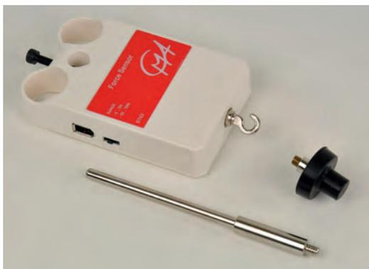
Der Kraftsensor misst Druck- und Zugkräfte mit Hilfe eines Dehnungsmessstreifens in einer elektrischen Brückenschaltung.
