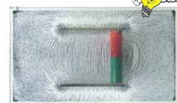
MAS 3.4.1 Kraftlinien um einen Hufeisenmagneten
