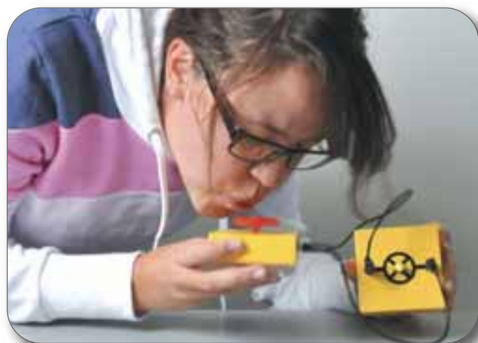
Puste (Windkraft) betreibt eine Glühlampe
