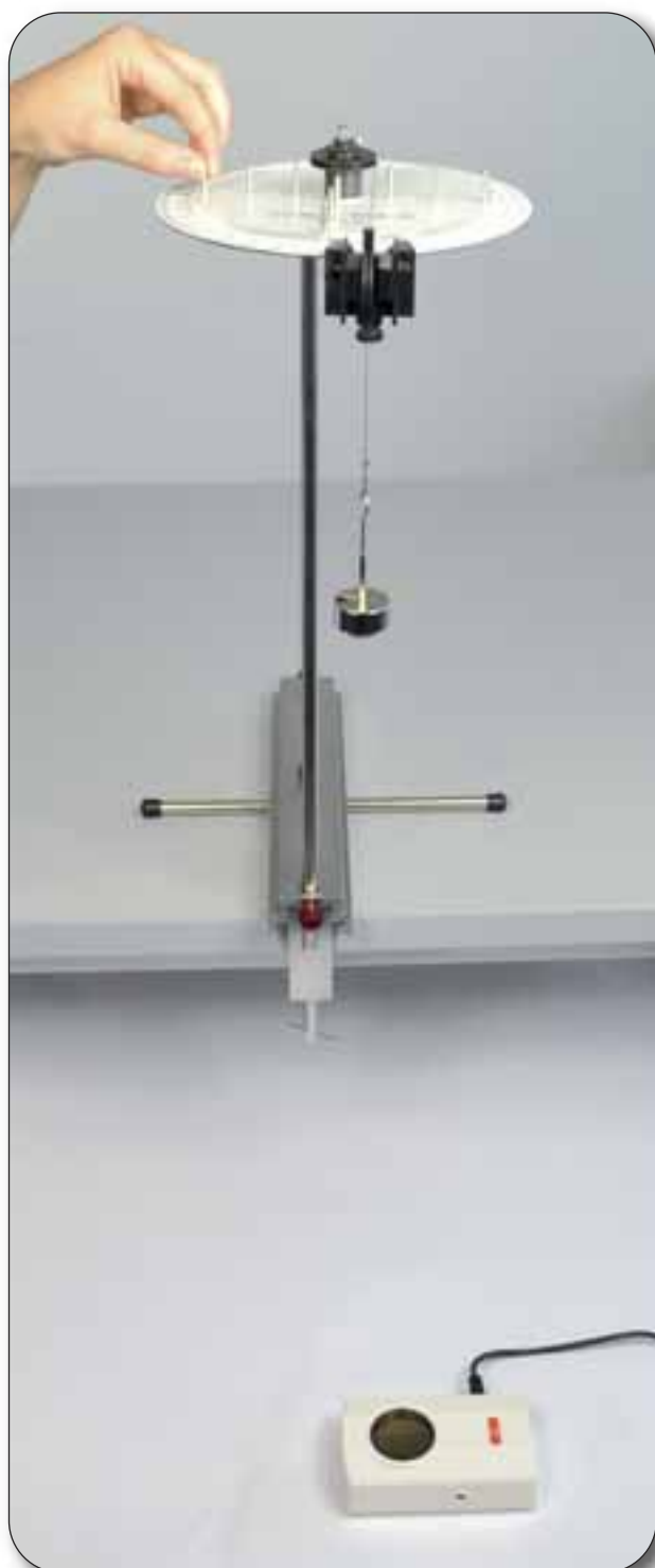
Winkel-Zeit-Gesetz einer gleichförmig beschleunigten Drehbewegung
