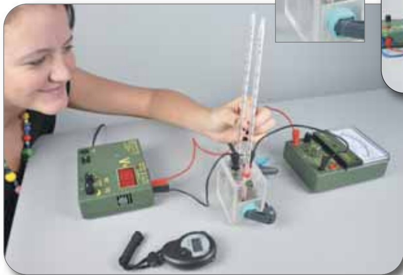
TDS 5.2 Thermoelektrische Kühlung, „Peltier Effekt“
