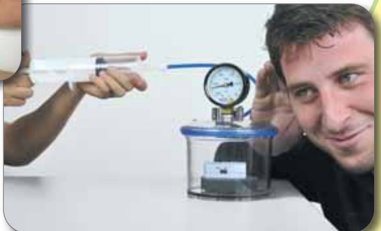
MELS 08 Schallübertragung im luftleeren Raum
