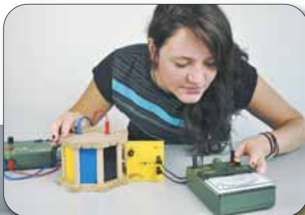
TDS 3.3 Wärmestrahlung (Leslie-Würfel) - quantitativ
