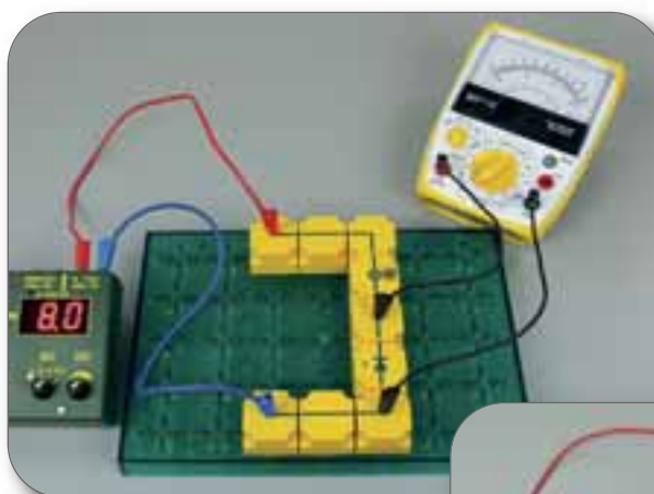
EOS 2.2 Die Durchlassspannung der Silizium-Diode
