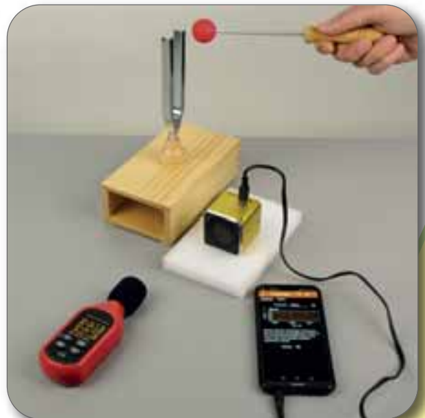
AKS 2.6c Schallpegel mehrerer Schallquellen
