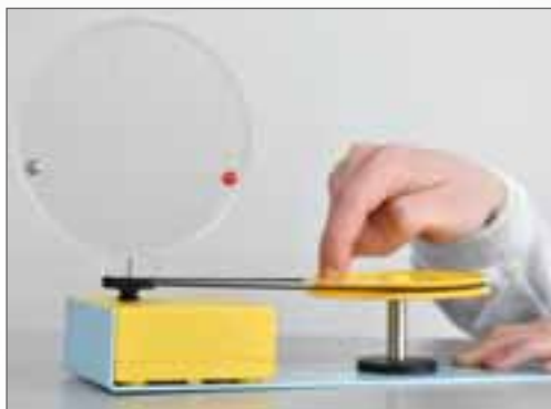
MEC 042 Zentrifugalkraft - Kugelschwebe
