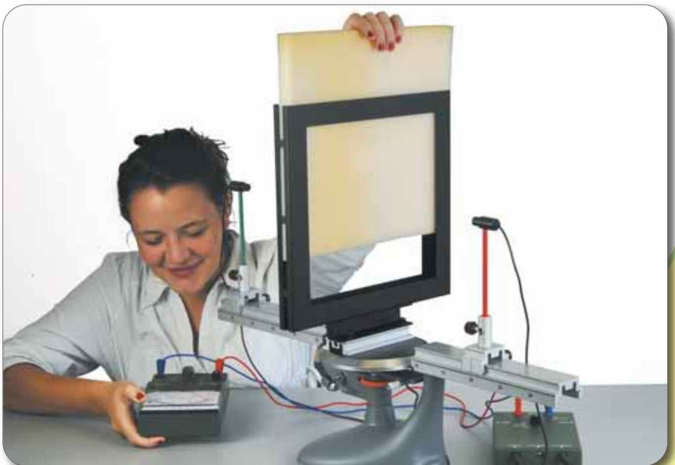
US 08 Absorption von Schallwellen an verschiedenen Materialien
