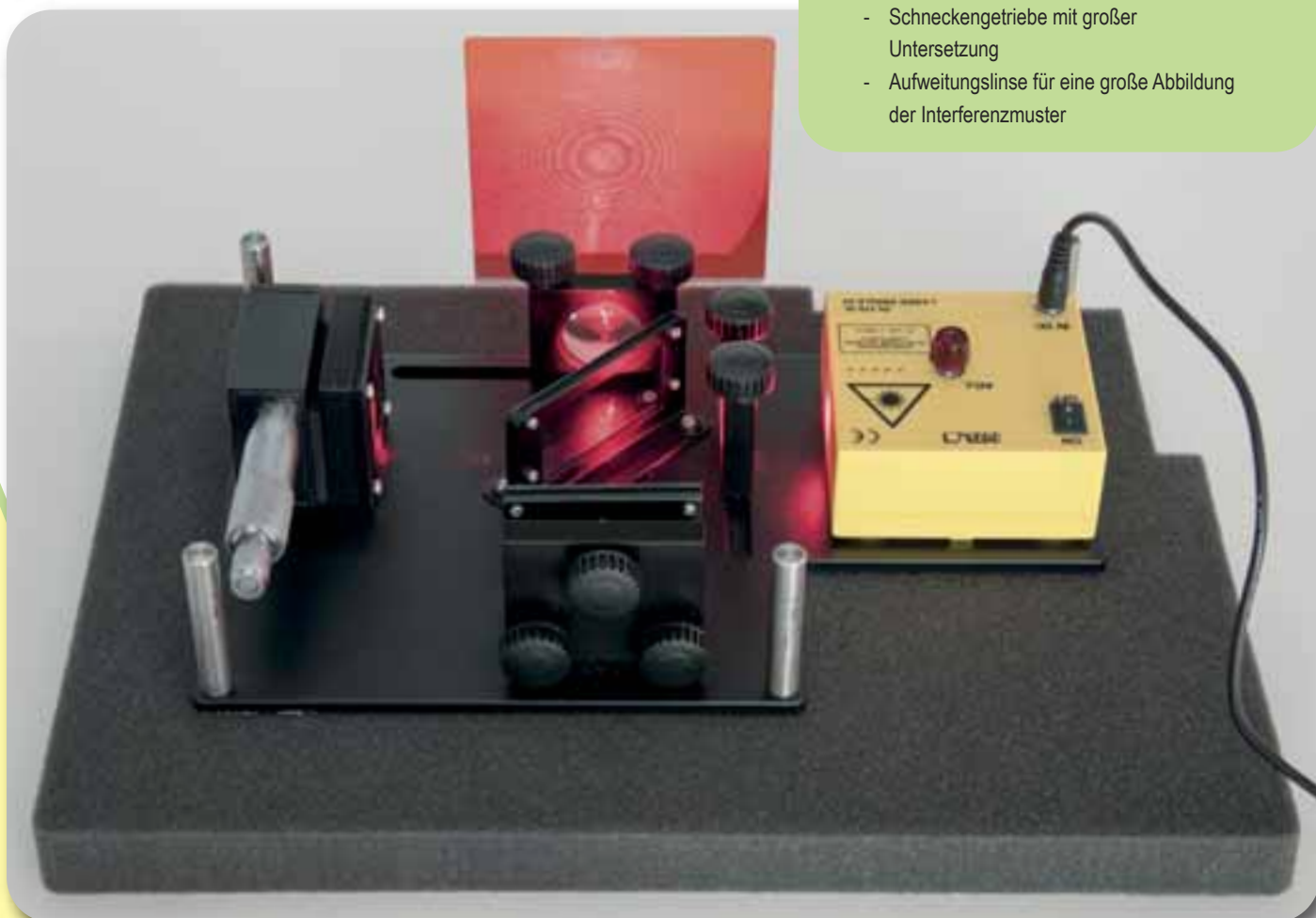
Versuchsaufbau mit dem Laser einfach 02, magnethaftend, DL110-2L. Dieses Lasermodell findet auch in der Boxeneinlage Platz.
