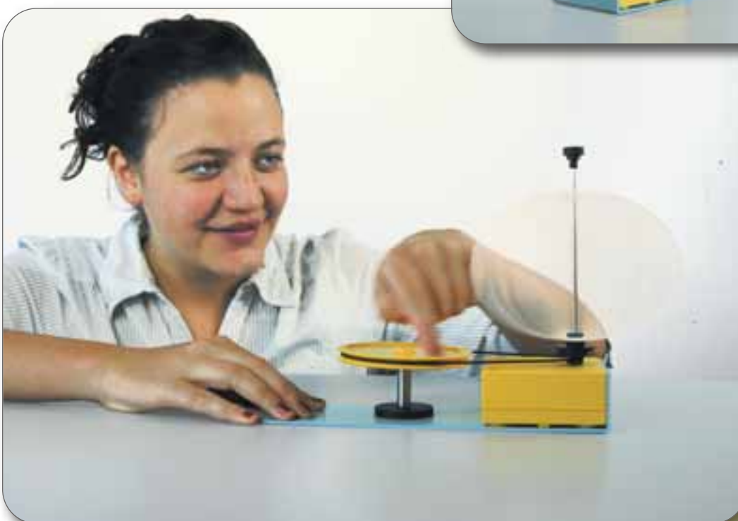
MEC 044 Zentrifugalkraft - Erdabplattungsringe
