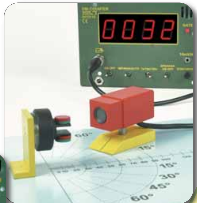
RAI 3.2 Das Verhalten von Betastrahlung im Magnetfeld
