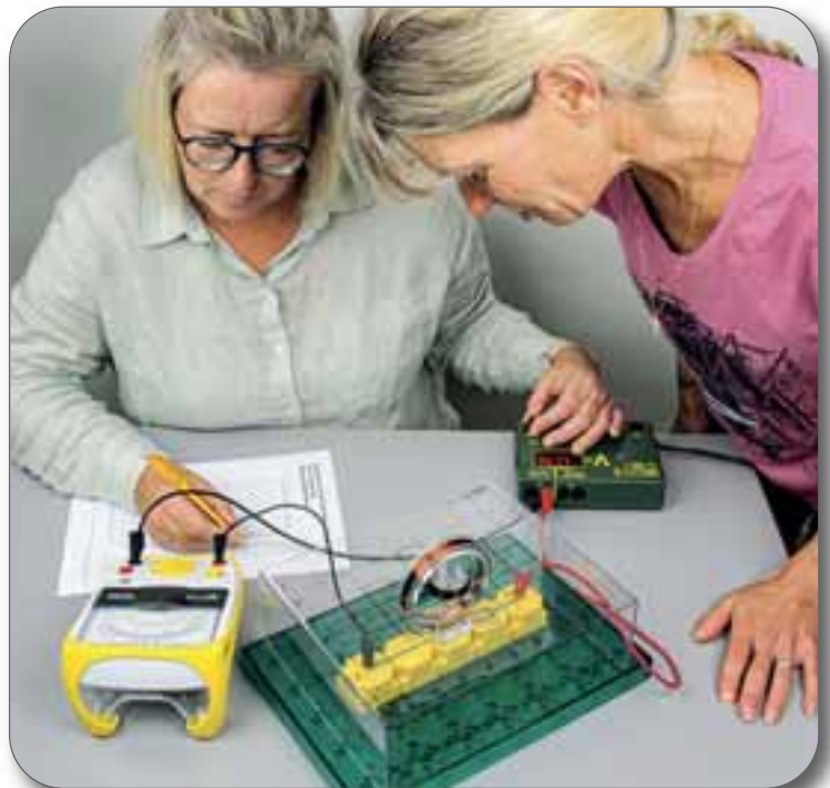
EMS 1.3 Beziehung der Stromstärke zum Tangens des Ablenkungswinkels
