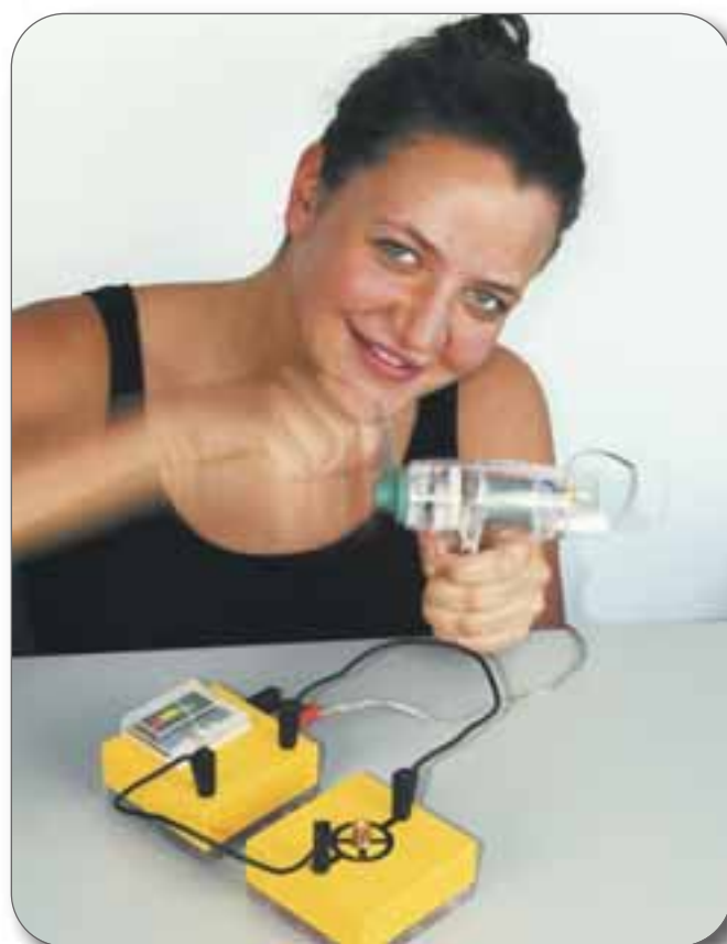
Energiespeicher mit Anzeige (Prinzip von Hybridantrieben)
